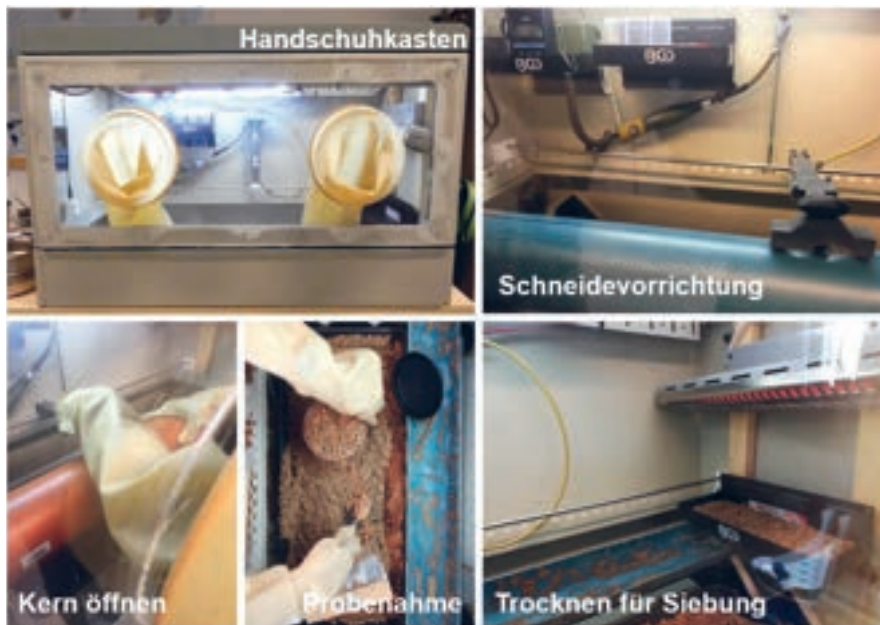
Probenaufbereitung unter Sauerstoffabschluss
