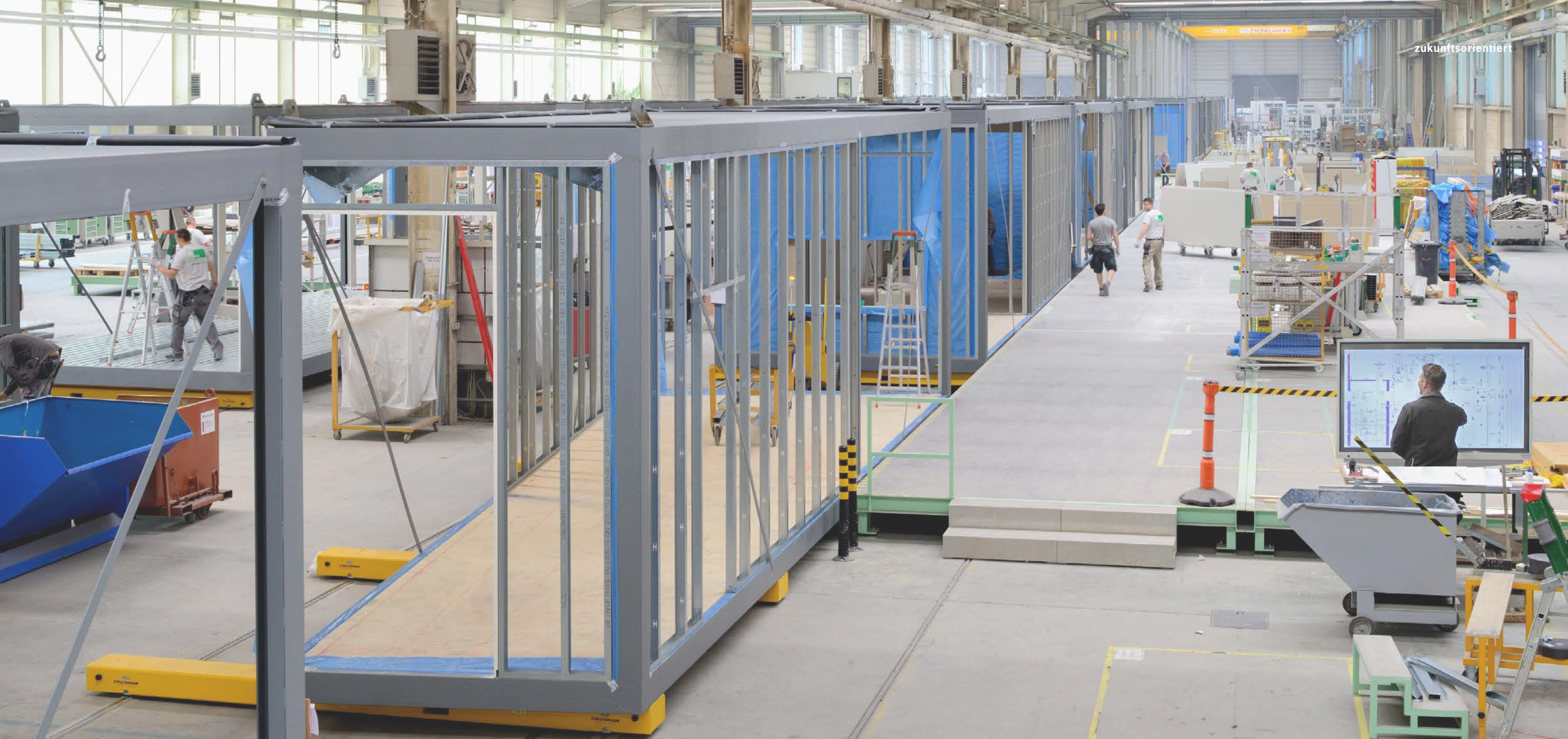
Die serielle Fertigung in der ALHO Raumfabrik
